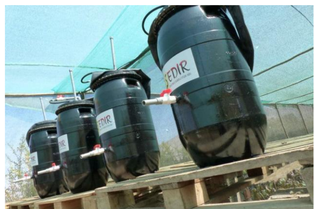
Figura 1. Biodigestores por lote, usados en el proceso fermentativo de la materia orgánica. Se observan los tratamientos en estudio, así como el control.
