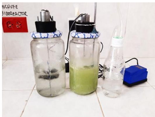
Figura 3. Biorreactor control (transparente) e inoculado (verde) con P. aeruginosa al 15 % en la degradación del lubricante SAE 20W50 a las 144 h.
