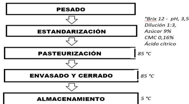
Fig. 2. Flujo de obtención de bebida no alcohólica (néctar) de Pouteria sapota “zapote mamey”
