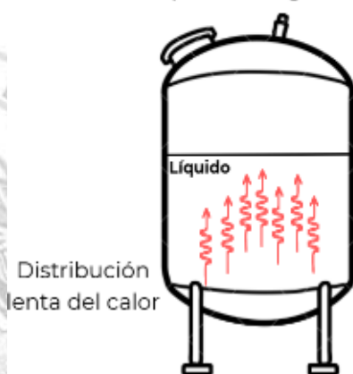
Figura 1. Principios de la transferencia de calor por convección natural y forzada en tanques pasteurizadores.
