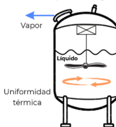
Figura 1. Principios de la transferencia de calor por convección natural y forzada en tanques pasteurizadores.
