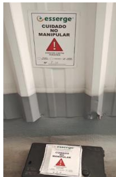
Figura 4. Barreras físicas de cebaderos para roedores instalado en el almacén de PT.
