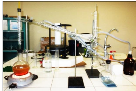
Figura 1. Equipo de destilación simple.
