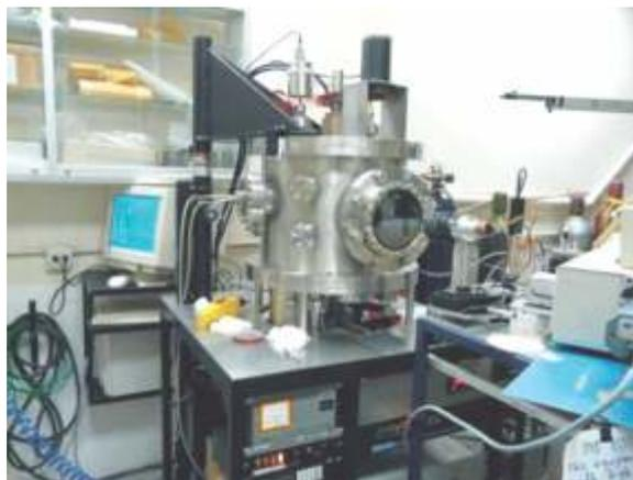
Figura 1. Cámara de vacío
