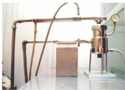
**Fig. 6.** Vista de prototipo a nivel piloto de equipo para la producción de extracto antociánico diseñado en base a escalamiento dimensional por programa Labview.
