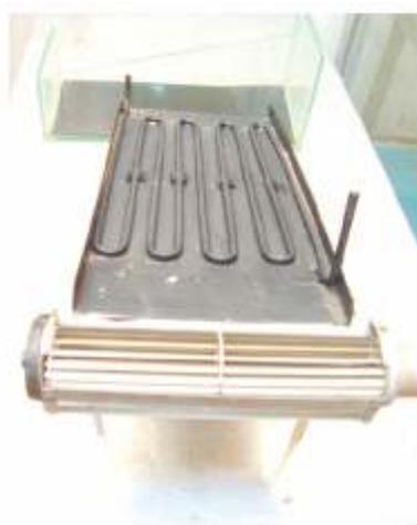
**Fig. 7.** Prototipo de Secador solar a donde se observa colector de acero inoxidable pintado de color negro mate de alta absorbancia.
