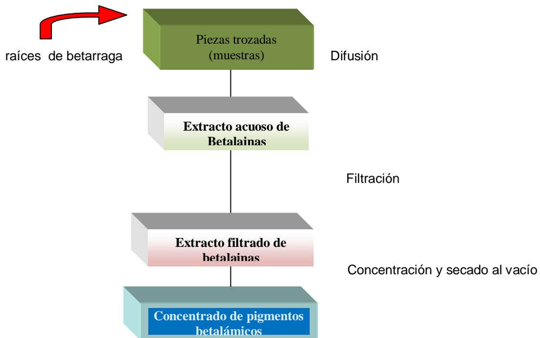
Fig. 1. Diagrama de flujo del proceso para la extracción de pigmentos betalámicos de betarraga.
