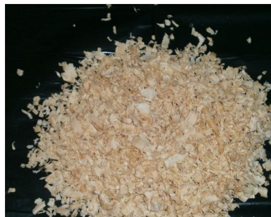
Fig. 1. Materia prima conformada por aserrín de Cedrelinga catanaeformis “tornillo” empleada para la producción de pellets energéticos por proceso de densificación.
