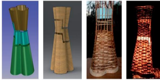
Figura 12. Integración de herramientas digitales para el desarrollo del producto artesanal en Rhinoceros 5, software que permite la creación de modelos de alta calidad, que pueden ser complementados con procesos CAE para realizar ajustes y mejoras, para luego emplear técnicas de prototipado rápido y fabricación aditiva.
